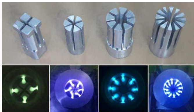
Рисунок 4. Варианты исполнения наконечников разрядника и соответствующие виды разрядов в них.
