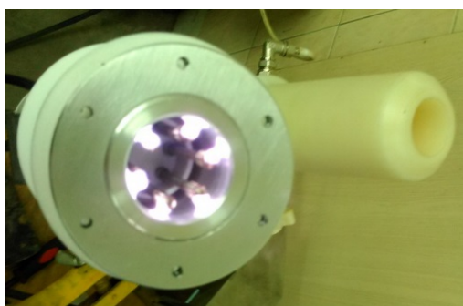
Рисунок 2. Аппликатор установки «Пластер-СВЧ» в работе
