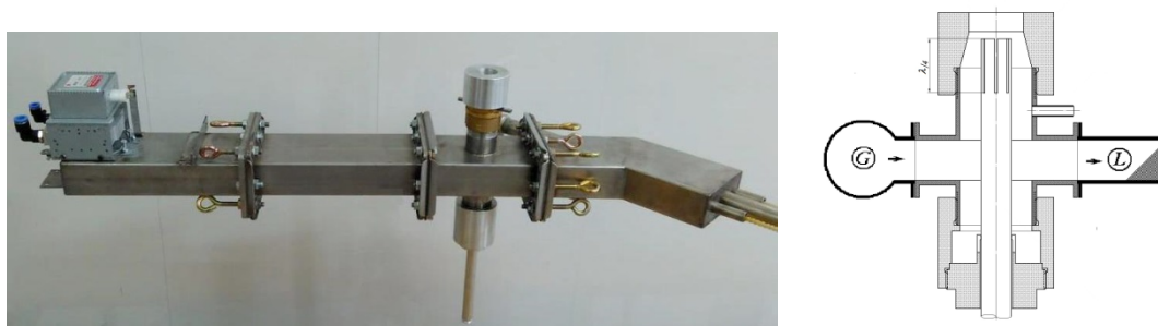
Рисунок 3. Волноводный тракт микроволнового источника АНТ-плазмы и схема его конструкции.
