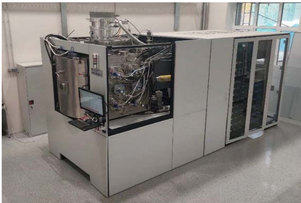
Рисунок 1 – Установка вакуумно-дугового напыления «Кремень-2»
