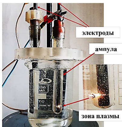
Рис. 1. Фотография ячейки для обработки раствора нитрофураля диафрагменным разрядом
