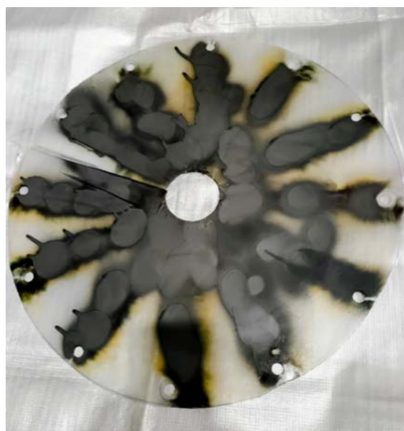
Рис. 5 Фото полиэтиленового кольца с нанесенным графитовым покрытием после нескольких «выстрелов» на воздухе , диаметром 30 см
